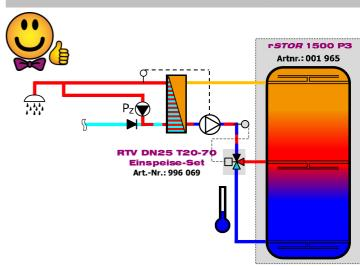
Zerstörung der Heißwasserzone beim Einspeisen
