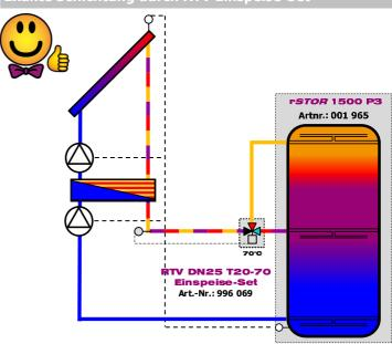
Zerstörung der Heißwasserzone beim Einspeisen
